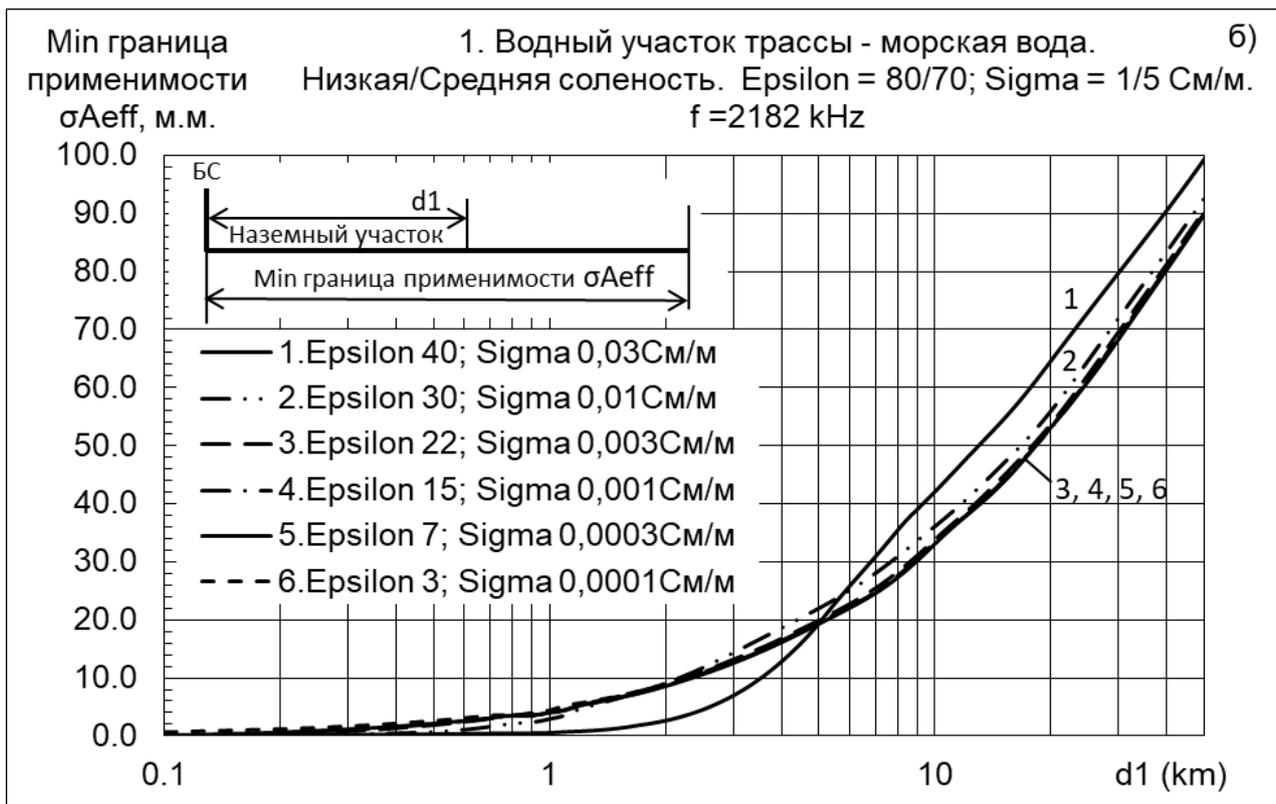
Рисунок Г4 – Зависимость коэффициента  $\sigma A_{eff}$  (а) и границы применимости коэффициента  $\sigma A_{eff}$  (б) от протяженности наземного участка  $d_1$  для различных свойств подстилающей поверхности наземного участка трассы при морском участке трассы в виде морской воды низкой/средней солености с  $\varepsilon = 80/70$  и  $\sigma = 1/5$  См/м на частоте  $f = 2182$  кГц
