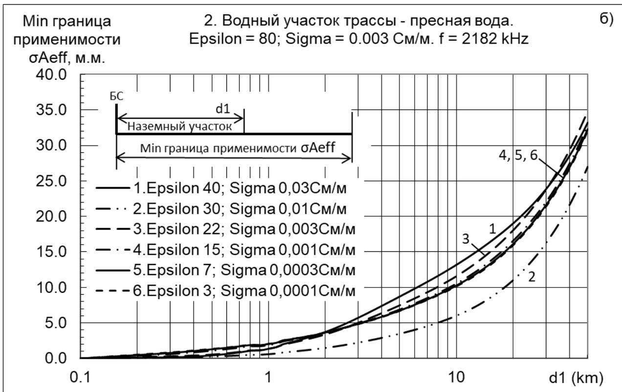
Рисунок Г5 – Зависимость коэффициента  $\sigma A_{eff}$  (а) и границы применимости коэффициента  $\sigma A_{eff}$  (б) от протяженности наземного участка  $d_1$  для различных свойств подстилающей поверхности наземного участка трассы при морском участке трассы в виде пресной воды с  $\varepsilon = 80$  и  $\sigma = 0,003$  См/м на частоте  $f = 2182$  кГц
