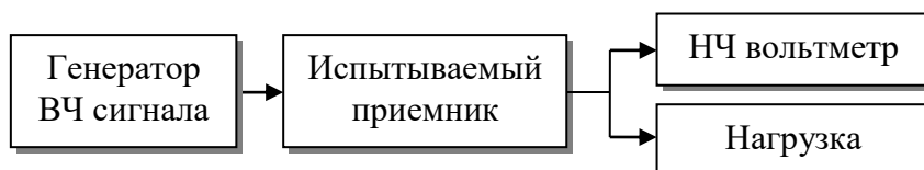
Рисунок 1 – Схема измерения номинальной чувствительности приемника в режиме телефонии с помощью стандартных средств измерения.
