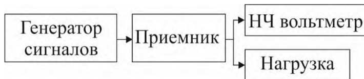
Рисунок 7. – Схема измерения номинальной чувствительности ПРМ в режиме телефонии с помощью стандартных средств измерения.
