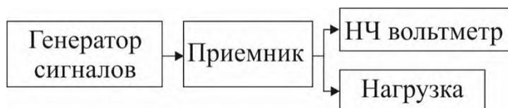
Рисунок 4 – Схема измерения номинальной чувствительности приемника.
