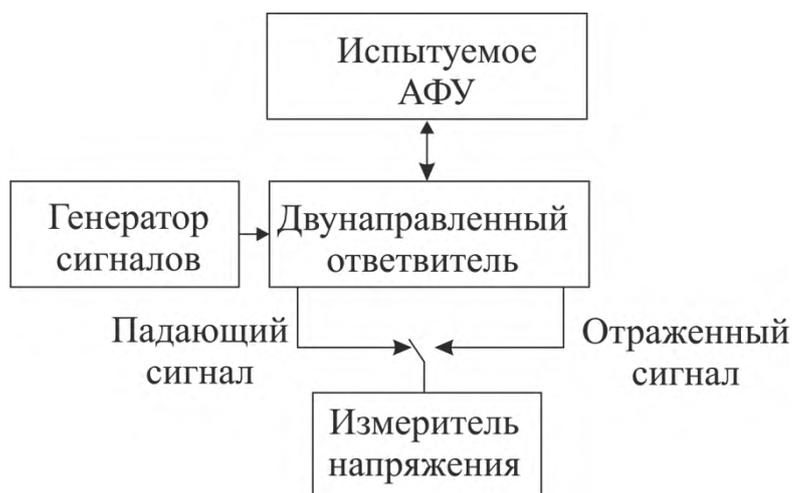
Рисунок 4 – Схема измерения КСВ антенно-фидерного устройства.
