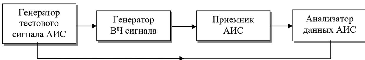
Рисунок 8 – Схема измерения номинальной чувствительности ПРМ АИС.
